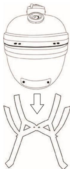
KORAK 4 – Postavite Kamado roštilj na nosač tako da otvor okrenete prema prednjem dijelu nosača omogućavajući otvaranje i zatvaranje otvora bez ikakvih smetnji.
